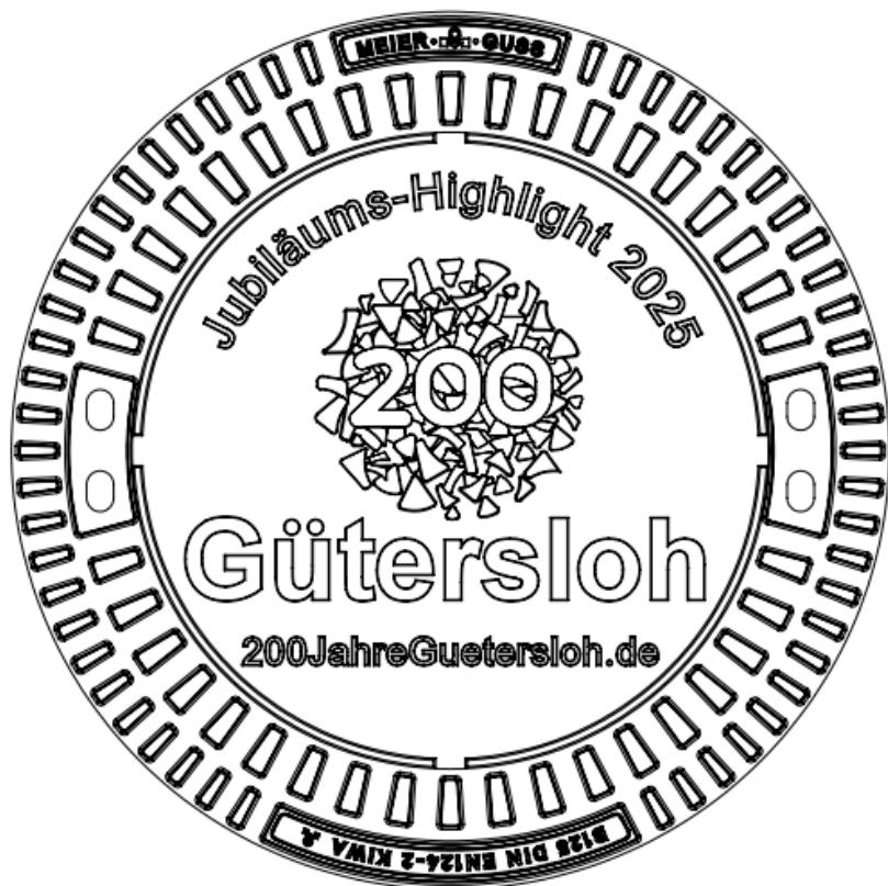
Bei dem Deckel handelt es sich um einen Deckel der Klasse B. Das bedeutet, dass dieser Deckel für Gehwege, Fußgängerzonen und vergleichbare Flächen, PKW-Parkflächen und PKW-Parkdecks geeignet ist – also auch für private Einfahrten ohne Lkw-Verkehr. Die Prüflast beträgt 12,5 Tonnen. Das Gewicht des Deckels beträgt rd. 35,5 kg. Die Maße sind alle in mm.
